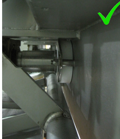
El eje se separa de la pared de la mezcladora para evitar el ingreso del aceite o grasa.
